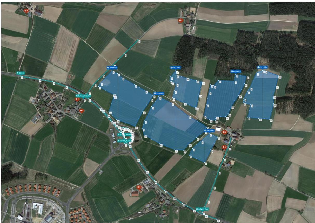
Abbildung 12: PV-Anlage und Immissionsorte in der Simulationssoftware ForgeSolar
