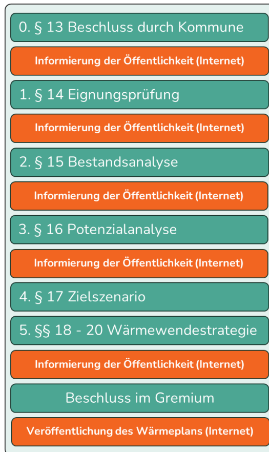
Abbildung 2: Ablauf einer Wärmeplanung nach § 13 WPG
